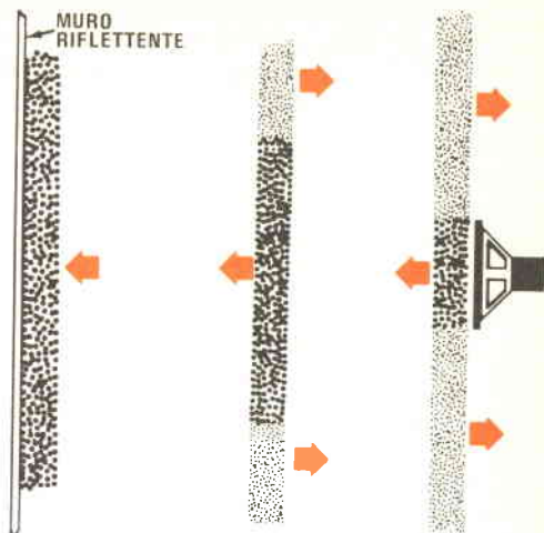
Fig. 1 - Quando vengono eccitate delle risonanze, nelle zone dove le onde riflesse si combinano in fase con le onde emesse dall'altoparlante si hanno intense fluttuazioni di pressione.
